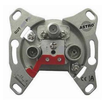
Prise unique antenne, domaine de fréquences 5-2150 MHz, sorties: TV, radio, 1 x SAT-F, passage alimentation stabilisée, système monocâble SCR (EN50494)/système Unicable, programmable
